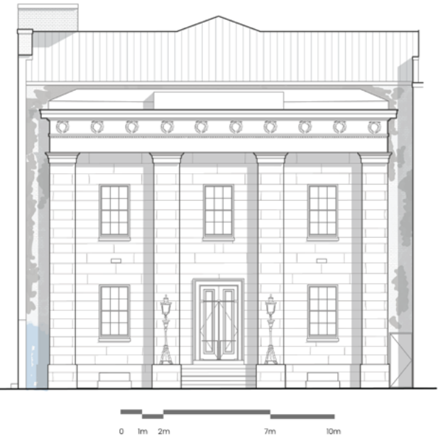
Elevation de la façade ouest caractérisée par ses quatre piliers toscans carrés et sa pierre de parement
